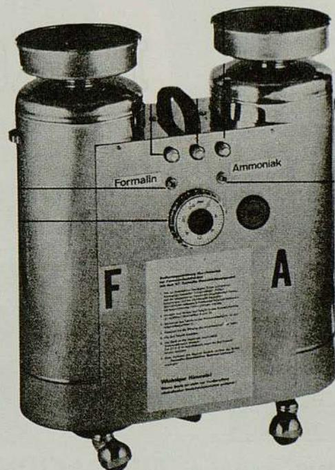
El aparato FORMALINTEC se utiliza para la desinfección y esterilización de locales y cuanto en ellos se encuentra contenido, según el principio ideado y experimentado a principios de siglo por el Profesor Flügge.
