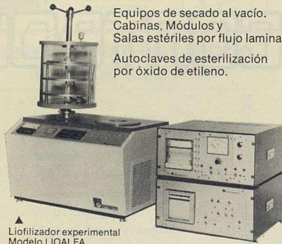
▲ Liofilizador experimental Modelo LIOALFA.
