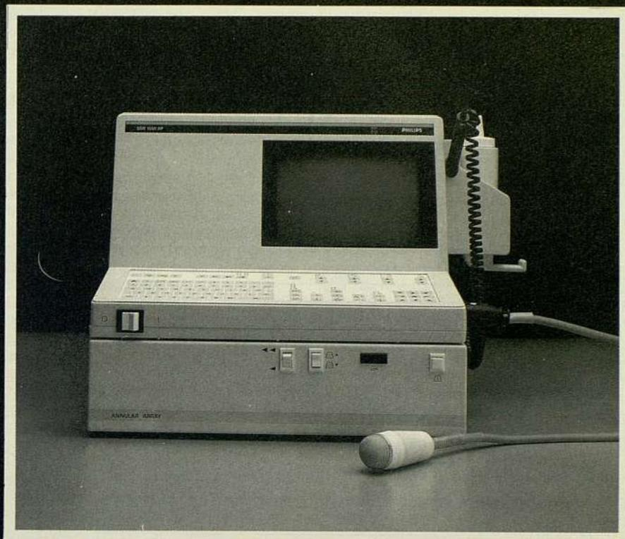
la zona de enfoque en cualquier dirección perpendicular al eje de transmisión, con lo que la resolución lateral es idéntica en todo el frente de onda, a diferencia de lo que sucede con los transductores electrónicos convencionales. Además, la zona de enfoque es más larga que en otro tipo de transductores y es posicionable por el operador en la zona de interés, continuamente desplazable entre la parte proximal y la distal de la imagen.
