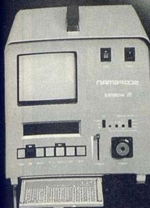
Puede grabar simultáneamente en cinta de video o fotografiar en papel térmico mediante una video-impresora.
